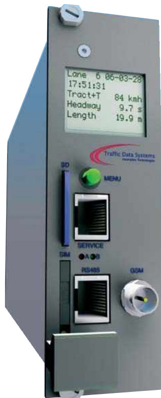
TMCS como módulo de 19 pulgadas con 8TE/3HE. Los elementos de mando así como los conectores para las tarjetas SIM y SD son cómodamente accesibles por delante.
