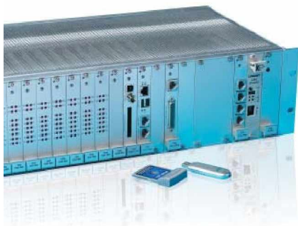
Módulo de 19 pulgadas TDS 821R con módulo de mando, FG1, FG2 y FG 6
