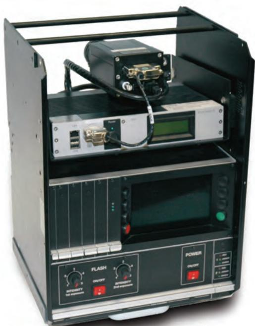
El **Multaradar C** también se puede instalar en la cabina normalizada por la Dirección General de Tráfico (según norma UNE 199121-1), una cabina de suelo para ubicación en lateral de calzada, en construcción de acero laminado en caliente con un elevado grado de blindaje, especialmente recomendada para vías y carreteras en las que se requiere el máximo grado de seguridad.
